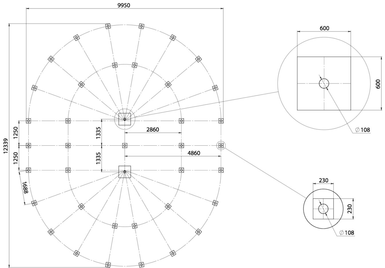
Возможно применение ленточного или монолитного фундамента; комбинирование свай по периметру и бетонной опоры в центре; иные виды фундаментов.
