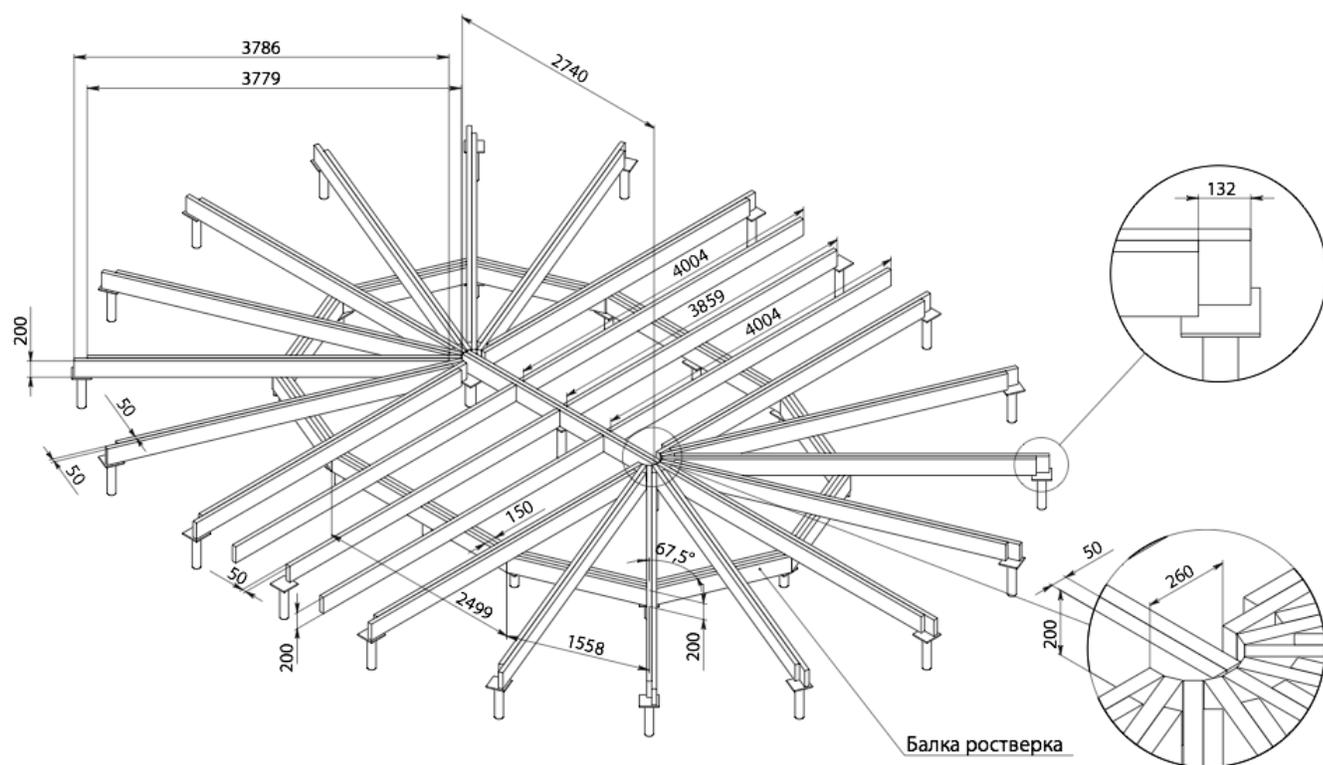
Лаги пола и балки ростверка в комплект поставки не входят, изготавливаются на месте из сухого пиломатериала.
