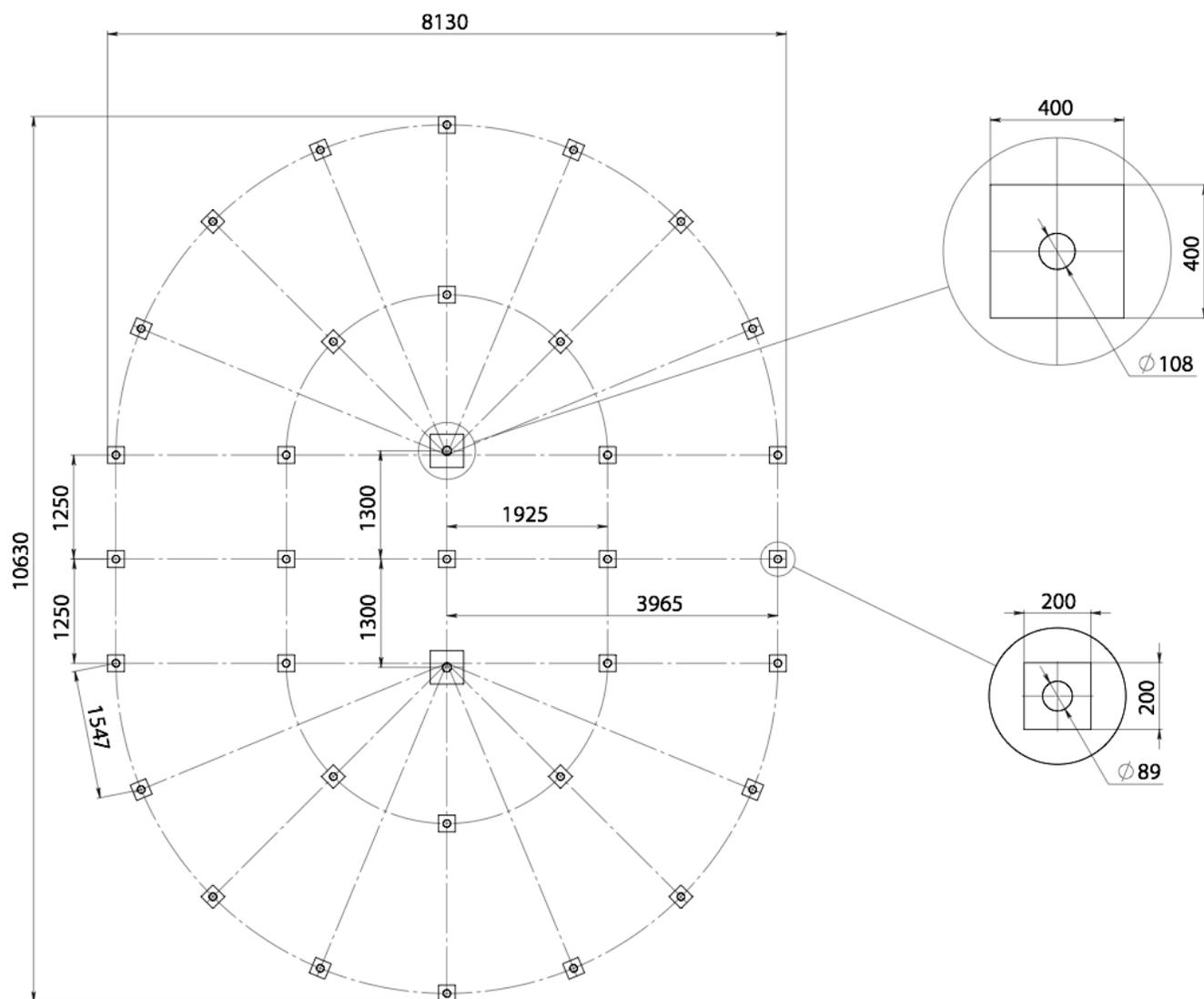
Возможно применение ленточного или монолитного фундамента; комбинирование свай по периметру и бетонной опоры в центре; иные виды фундамента.
