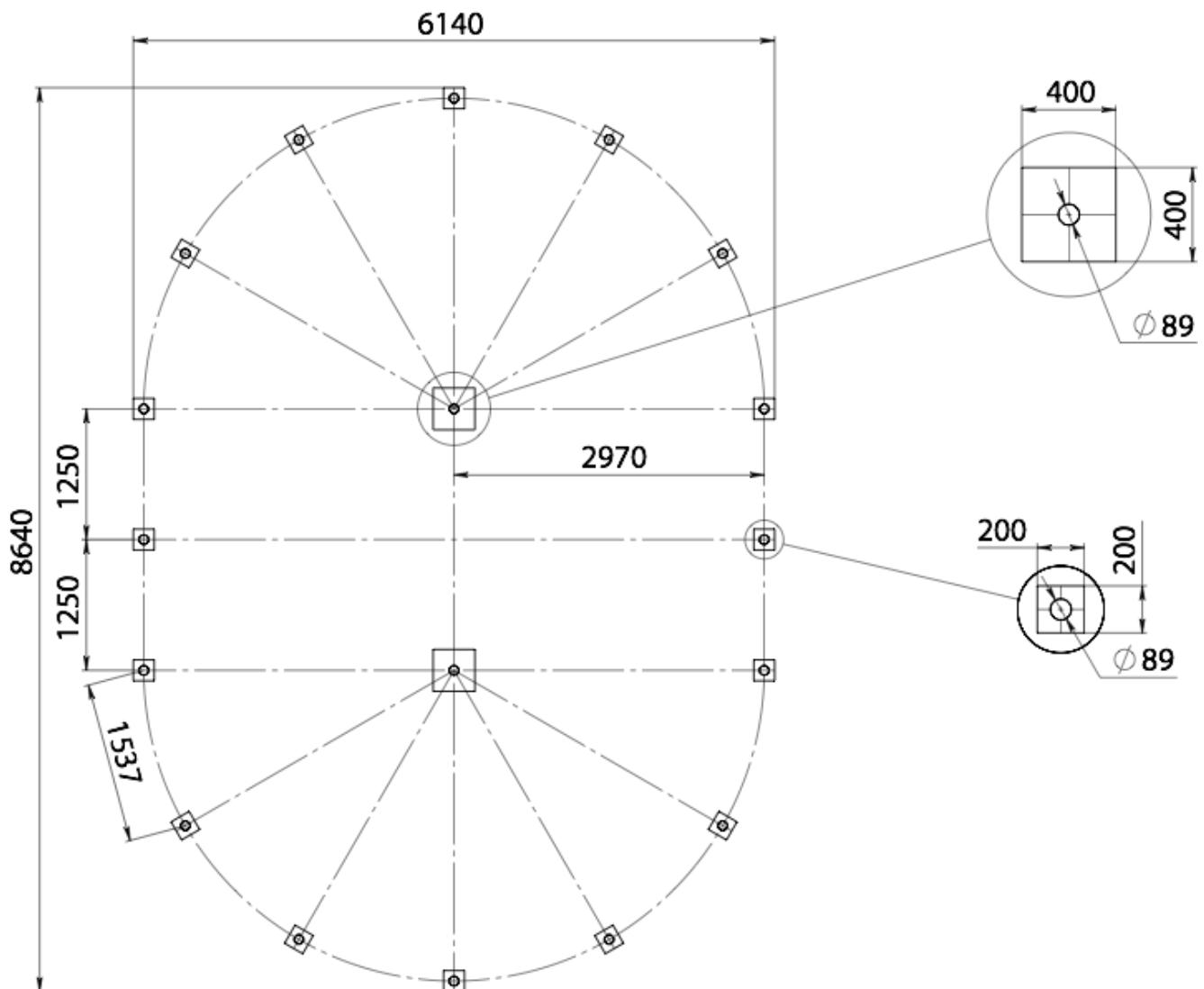
Возможно применение ленточного или монолитного фундамента; комбинирование свай по периметру и бетонной опоры в центре; иные виды фундаментов.
