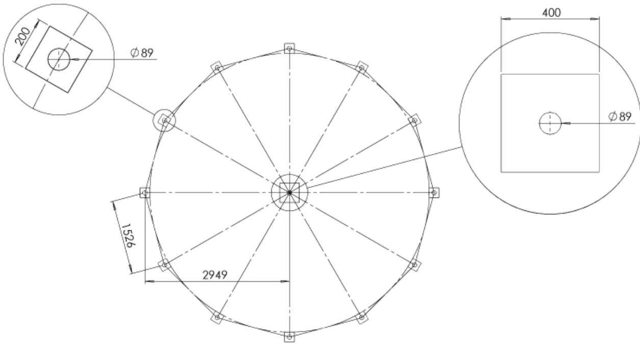
Возможно применение ленточного или монолитного фундамента; комбинирование свай по периметру и бетонной опоры в центре; иные виды фундаментов.
