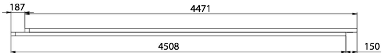
Опоры лаг пола и сами лаги пола второго этажа - это обычные доски хвойных пород. Крепежные накладки делаются из ФСФ фанеры толщиной 30 мм. Рекомендуем оставлять достаточный второй свет для организации лестницы и максимальной эстетики конструкции.
