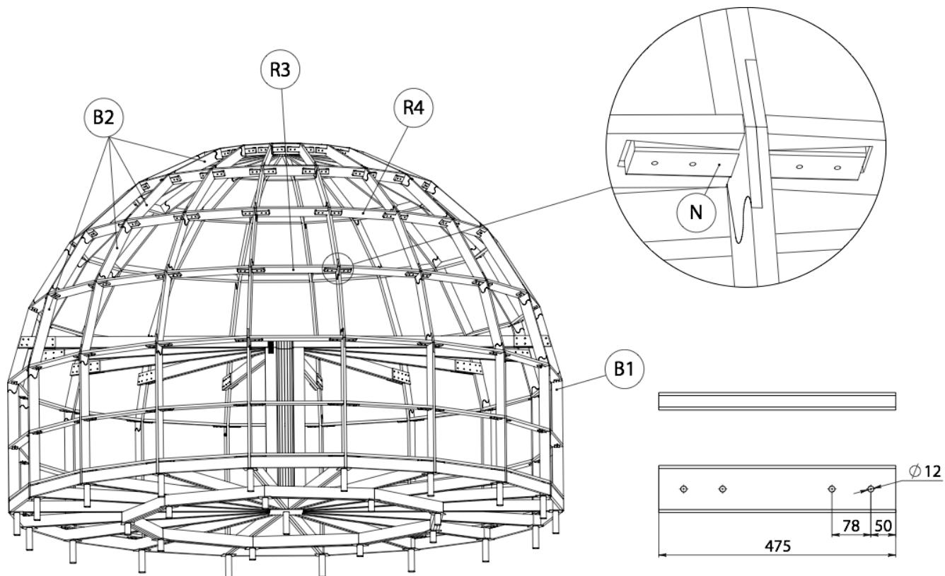
Просверлите нагель и распорку насеквость. Показаны отверстия и их расположение. Закрепите распорку и нагель с помощью болта M12 с гайкой и широкими шайбами с обеих сторон. Всего по 4 болта на каждый нагель.
