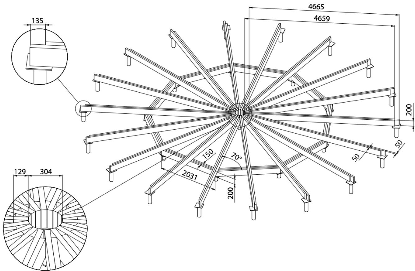
Лаги пола и балки ростверка в комплект поставки не входят, изготавливаются на месте из сухого пиломатериала.
