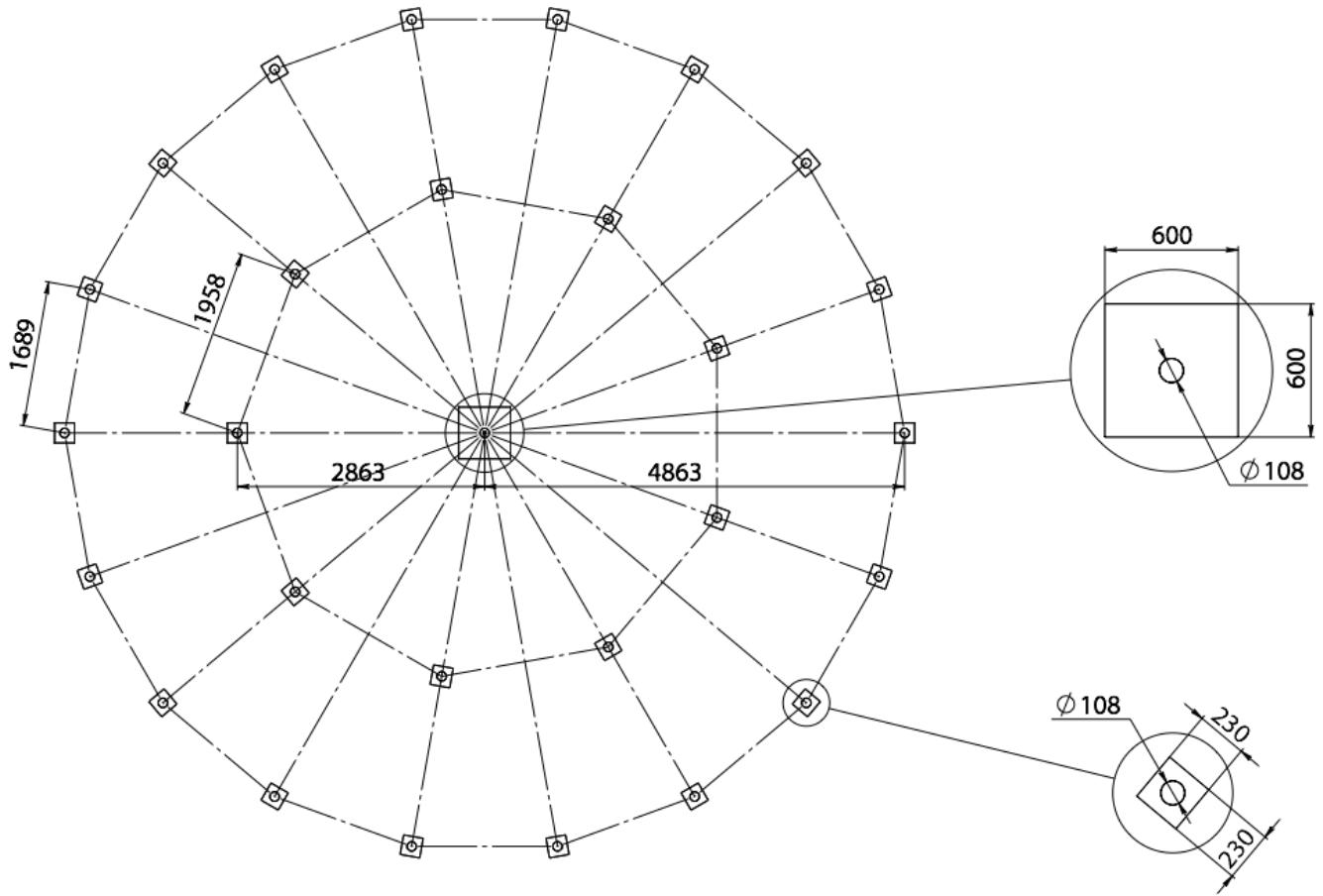
Возможно применение ленточного или монолитного фундамента; комбинирование свай по периметру и бетонной опоры в центре; иные виды фундаментов.
